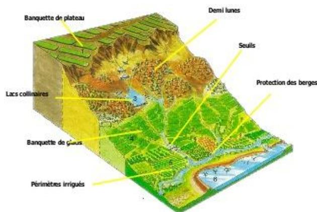
Figure 6 : Schémas d'aménagement d'un BV
